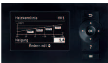
Nová regulácia Vitotronic – jednoduchá obsluha vďaka výnimočnému, intuitívnemu ovládaniu a grafickému displeju, ako napr. grafické zobrazenie priebehu vykurovacej krivky
